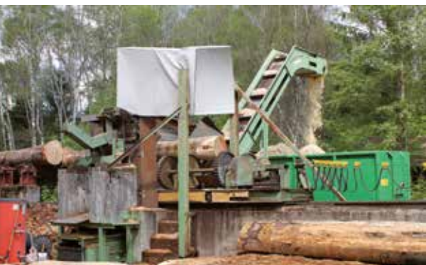
Die Starkholzstämmen werden auf dem Gelände des Sägewerks entrindet.
