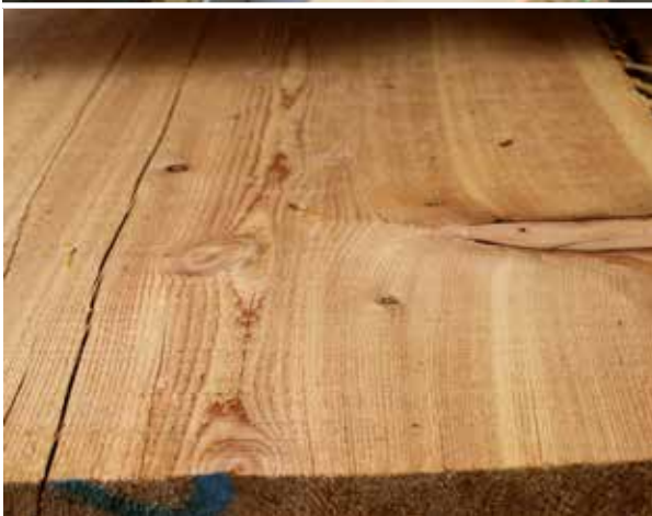
Hier ein Beispiel von dem, was man nicht gerne in den Brettern findet. Links die sogenannte Ringschale, rechts ein Flügelast.
